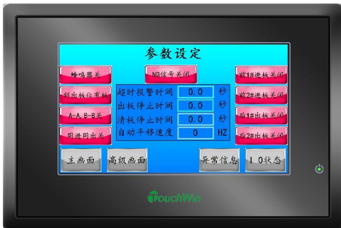
该画面可以设定时间移载速度和对前后SMEMA信号进行有效/无效切换
